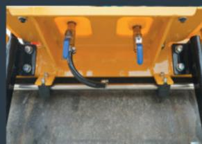
Система орошения с долговечной трубкой из нержавеющей стали
