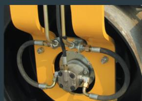
Гидравлический мотор Sauer с вибрацией на переднем и заднем вальце
