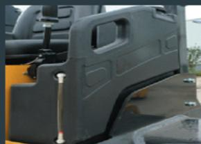
Установлен прочный пластиковый резервуар для воды для предотвращения ржавчины в спринклерной системе
