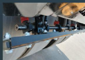
Спринклерный ороситель с высококачественным насосом, система интервального распыления, легкодоступные форсунки с защитой от ветра
