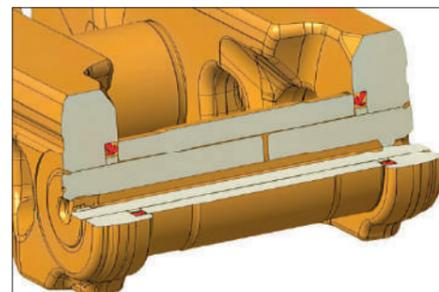
Инновационный шарнир PPR (Positive Pin Retention) для тяжелых бульдозеров
