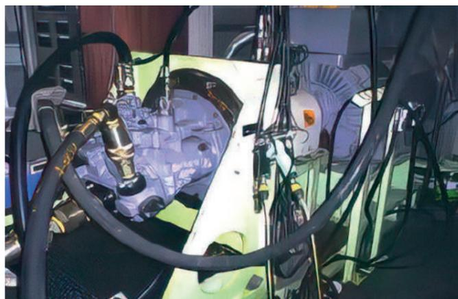
Стенд для испытаний гидромоторов, гидронасосов
