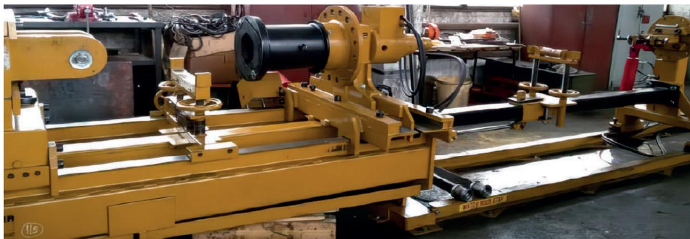
Стенд для ремонта гидроцилиндров
